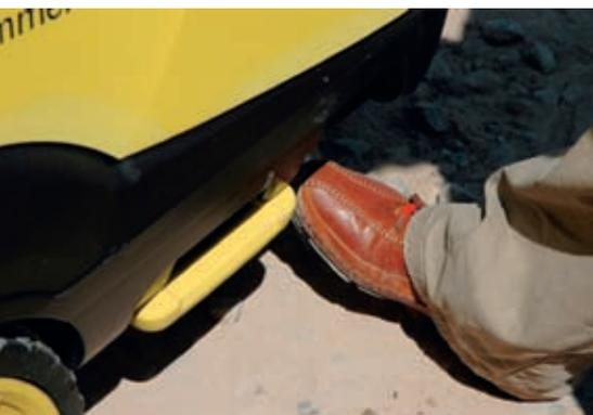
Zentrales Feststellpedal, ausziehbarer Tragegriff und Gabelstapleraufnahmepunkt sind neue Details
