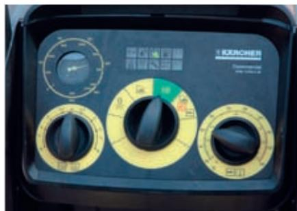
Instrumententafel mit dem Dosierregler für die Reinigungsmittel, Hauptschalter und Temperaturregler
