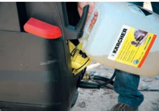
Die Tanks für die Reinigungsmittel lassen sich auch aus großen Gebinden gut über Stützen befüllen
