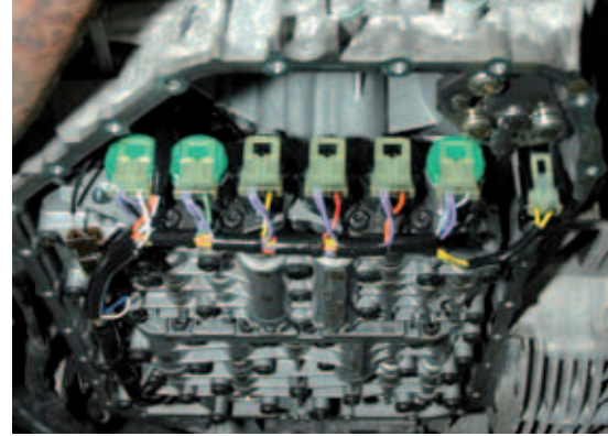
Schaltventile eines Automatikgetriebes...
