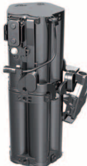
Kondensator des i-Loop-Systems im Mazda Takeri
