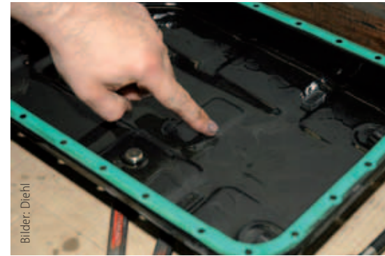
... und Ablagerungen in dessen Ölwanne
