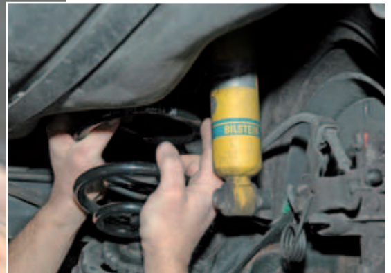
Bei Vertreter- oder häufig im Anhängerbetrieb bewegten Autos verstärkte Federn einbauen
