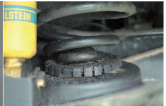
Federauflagen säubern, damit Steinchen die Beschichtung der neuen Federn nicht beschädigen
