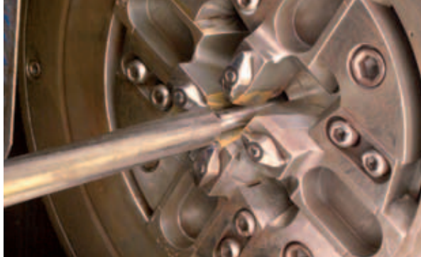
„Schälen“ des Stahldrahts (mindestens 0,5 mm). Zweck: Oberflächenfehler beseitigen und Soll-durchmesser erzielen. Es folgt eine Rissprüfung
