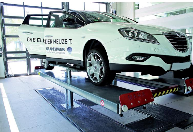
MAHA Zweistempelbühne ZS VARIO 3.5 FT mit Bodenausgleich, Radfreiheber
