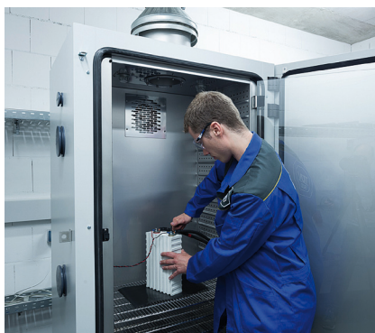
Im Labor des TÜV SÜD wird ein Kältetest für eine Batterie vorbereitet.
