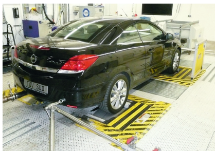
Die Nachrüst-Katalysatoren werden im TÜV SÜD-Abgaslabor in Heimsheim auf Herz und Nieren geprüft.
