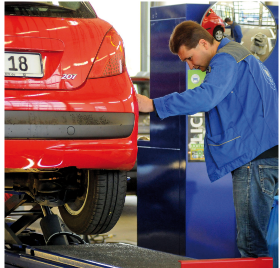
Ob die aktuelle Fahrzeugbereifung den zulässigen Größen gemäß der CoC-Papiere entspricht, wird auch im Rahmen der Hauptuntersuchung geprüft.
