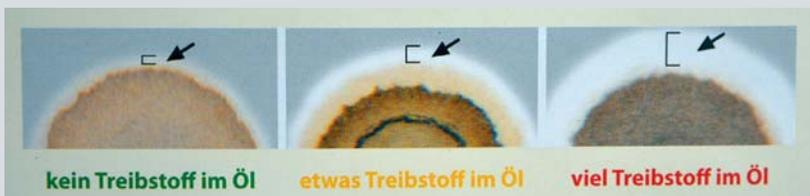
**Innerer Kreis:** Der innere Kreis zeigt die Verunreinigung des Öls durch Partikel wie Staub, Ruß oder Metallabrieb an. Bei einem hohen Rußanteil kann er Kreis zwei und drei überdecken.
