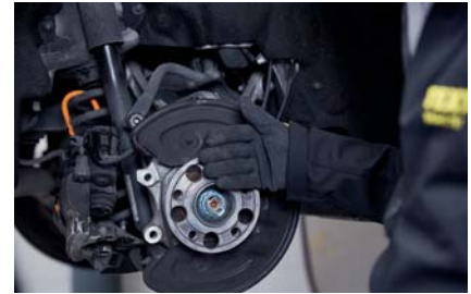
Selbst kleinste Verunreinigungen der Nabe sorgen für eine Unwucht der Bremsscheibe.
