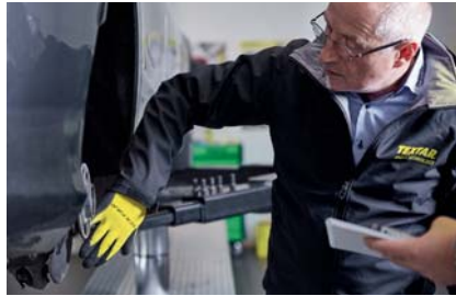
Die Radnabe sollte bei jedem Brems Scheibenwechsel kontrolliert werden.
