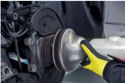
Mit einer Topfbürste lässt sich die Nabe von Schmutz und Rost befreien.
