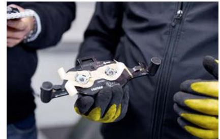
Laufrichtungsgebundene Bremsbeläge sind am Pfeil und an der Ansträgung erkennbar.
