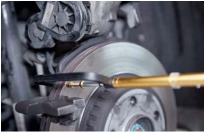
Die Dicke der Bremsscheibe lässt sich auch im eingebauten Zustand messen.
