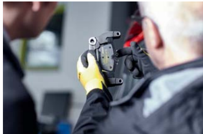
Klammern an den Bremsbelägen sollten in die entsprechenden Nuten eingeführt werden.
