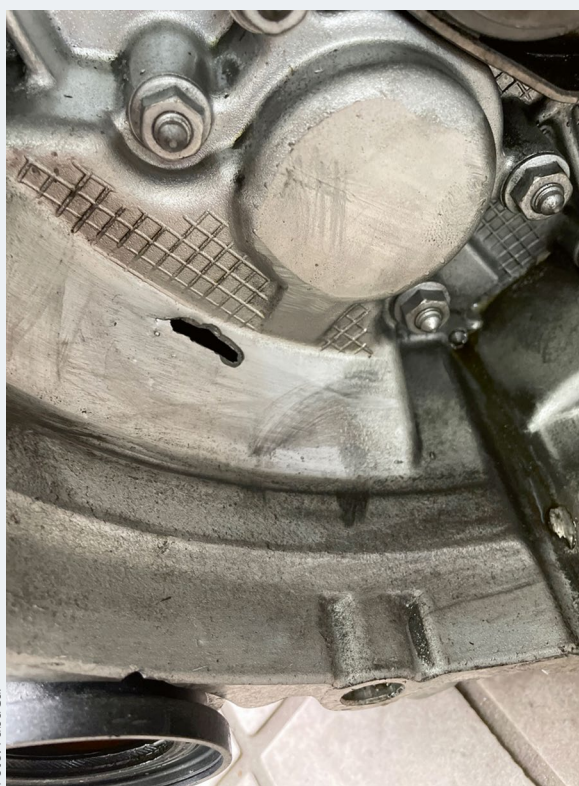
Das Loch auf der Kupplungsseite sorgt für den Ölverlust.
