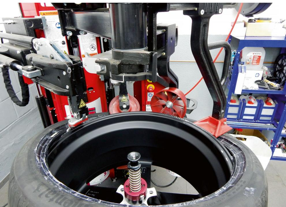
Einen Niederquerschnittsreifen auf eine 23-Zoll-Felge mit hinten liegendem Felgenbett aufzuziehen, ist für die Hunter Revolution kein Problem.
