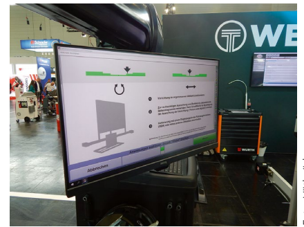
Balkendiagramme erleichtern die Positionierung des Targets vor dem Auto.
