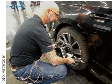
Björn Schleifer setzt die Reflektoren per Radklammer kratzfrei an der Felge an.
