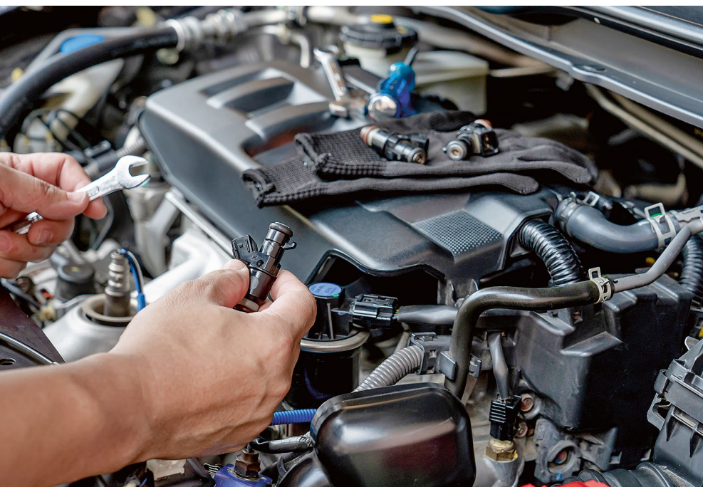
Startet der Motor nicht oder ist der Leerlauf unruhig, kann dies an den Einspritzventilen liegen.
