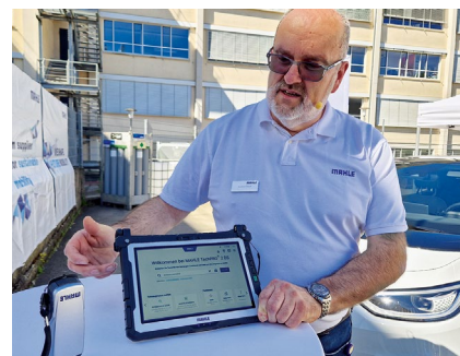
Die verbesserte Diagnoselösung TechPRO 2 enthält die Funktion E-Scan für die Batterie.
