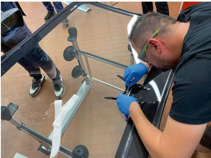
Präzisionsarbeit: ADAS-Bauteile müssen auf die neue Scheibe übertragen werden.
