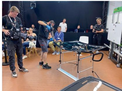
Der Spezialkleber von DuPont wird auf dem Rand der neuen Scheibe aufgetragen.
