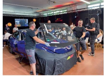
Erst dann lässt sich die alte Scheibe aus dem Tesla mit einem Spezialdraht austrennen.
