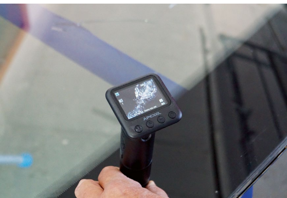
Die elektronische Lupe zeigt: Der Kratzer ist nur einige Zehntel Millimeter tief.
