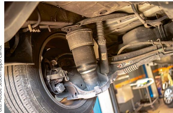
Luftfedern leiden an altersbedingtem Verschleiß durch Versprödung des Gummis.
