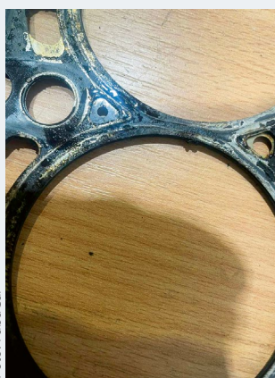
Dichtung und Zylinderkopf des VW Amarok sind beschädigt.
