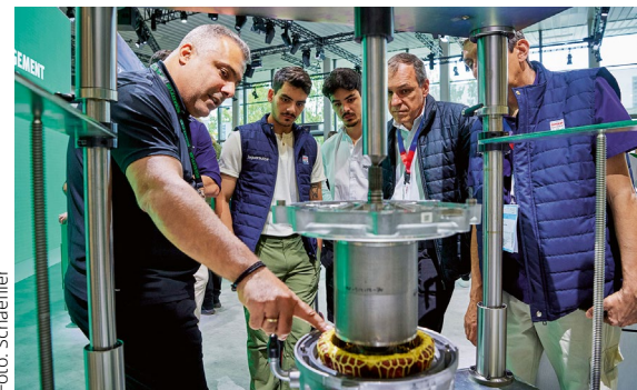
Schaeffler hat zusammen mit Deore ein System zur E-Motor-Demontage entwickelt.
